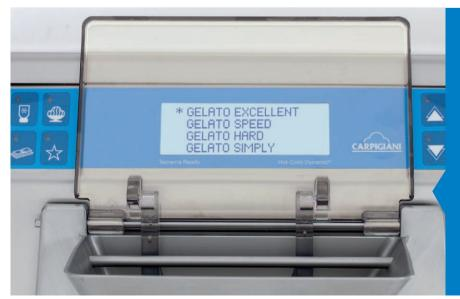
Personalisierbare Produktionsmenüs, damit NUR die am häufigsten verwendeten Produktionszyklen angezeigt werden.
