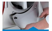
Die Eisrutsche ist einfach abzunehmen und erleichtert das Entfernen der gesamten Gelato-, Creme- und Schokoladerückstände für die vollständige Reinigung. **Gefrierzylinder und Frontblech bilden eine Einheit** für maximale Reinigung und Hygiene. Mit diesem Design werden auch alle Lücken hinter der Verkleidung ausgeschlossen, wo sich Kondensation und Eis bilden könnten, was die Lebensdauer der Maschine verkürzen würde.
