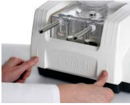
Auslöserarm am Motorsockel, geeignet für Links- und Rechtshänder
